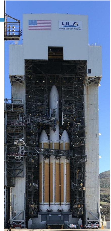
Мобильная башня MST для установки КГЧ на Delta IV Heavy
