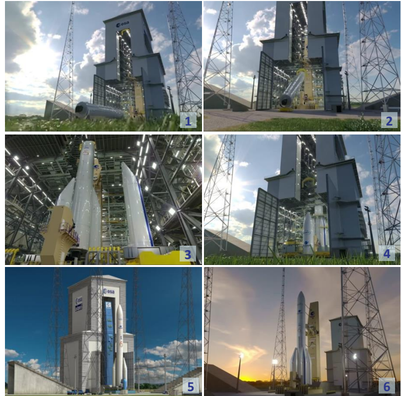
Последовательность сборки РН «Ariane-6»
