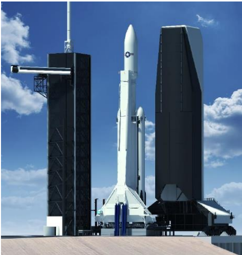
Мобильная башня 86 м для установки тяжелой ГЧ на Falcon Heavy
