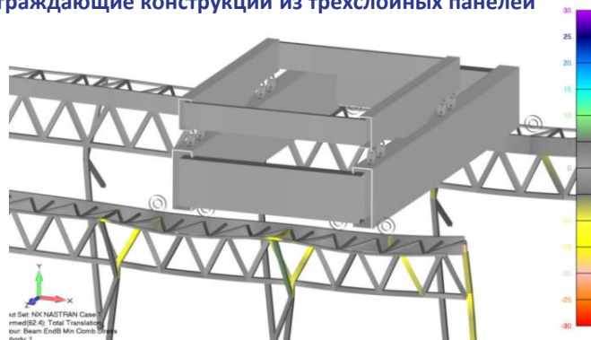
Результаты расчета подкрановых путей (кгс/мм 2 )
