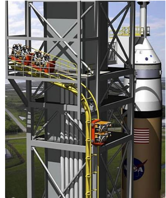
Спуск тележки с экипажем из KA Orion
