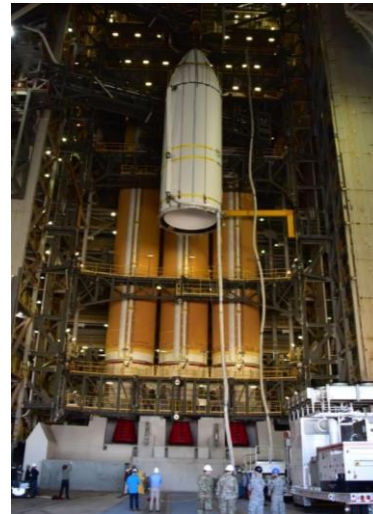
Мобильная башня MST для установки КГЧ на Delta IV Heavy
